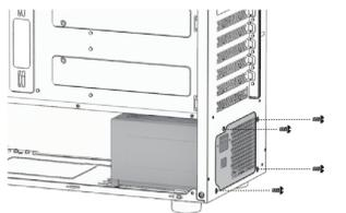
**5 2.5"SSD Installation/ Installation d'un SSD de 2,5"**
